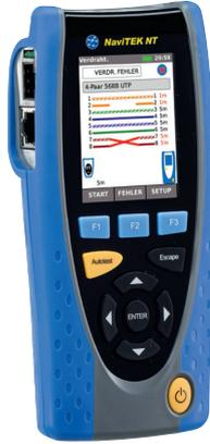
Der NaviTEK NT ist ein Netzwerktester zur Fehlersuche und Wartung in aktiven und passiven Kupferkabel- und Glasfasernetzen. Mit seiner optimierten grafischen Benutzeroberfläche ermöglicht der NaviTEK NT den Netzwerktechnikern Verbindungsstörungen im Netzwerk schneller als je zuvor zu identifizieren und zu beheben. Anschließend lassen sich die Tests als PDF-Bericht speichern und über die kostenlose TREND AnyWARE™ App an Kollegen und Kunden übermitteln.
