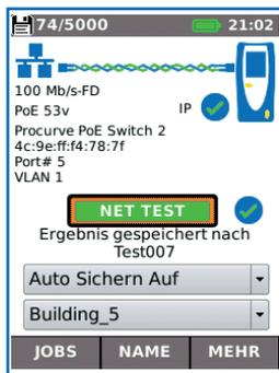
Nach Drücken der Autotest-Taste werden zusammenfassende Angaben angezeigt und die Netzwerkparameter können einzeln überprüft werden.
