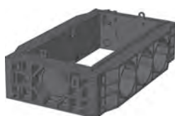
Rahmen 150 mm Art.-Nr.: 06 278 0052E 2 x Ø 30 / 1 x Ø 110 4 x Ø 30 / 3 x Ø 110 Gewicht: 7 kg
