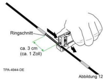
**Schritt 5:** Nach dem letzten 3-cm-Schnitt (ca. 1-Zoll-Schnitt) Kabelmantel vom Kabel entweder mit den Fingern, der Nadelzange, dem Kabelmesser oder der abgerundeten Klinge des Ideal-Werkzeugs abziehen. (Siehe Abbildung 4.)
