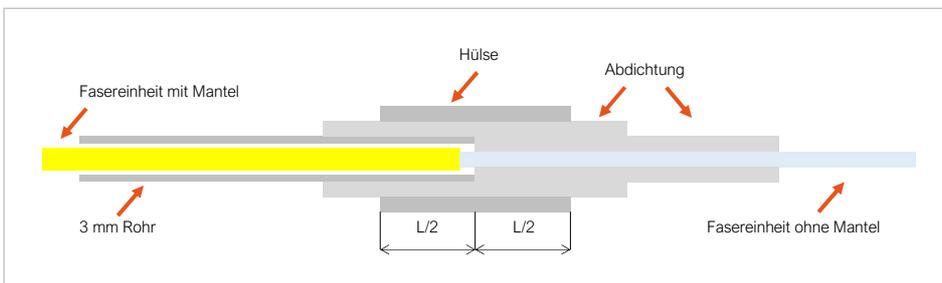
Passende Abdichtung (4f oder 12f) auf die Fasereinheit aufschieben
