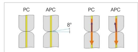
Endflächenausführung mit abgerundetem Faserende (PC) und zusätzlich gekippter Faserstirnfläche (APC) zur Erhöhung der Rückflussdämpfung (lichtführender Faserkern gelb dargestellt, Rückreflexionen durch blaue Pfeile angedeutet).
